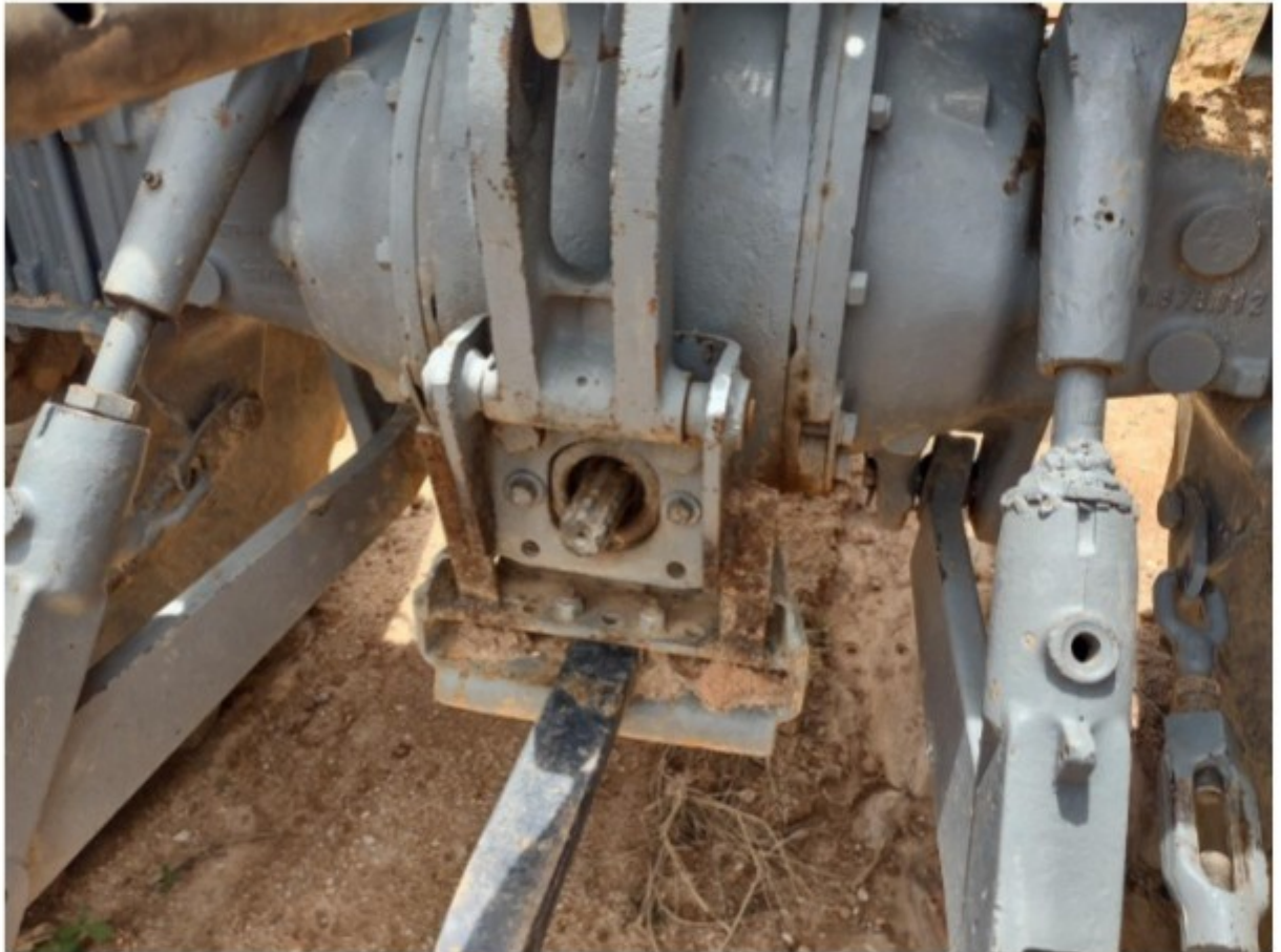
Foto 13: Trator Massey Ferguson 85 X, não foi instalada uma proteção que cobrisse a parte superior e as laterais da Tomada de Potência - TDP do trator - visão mais aproximada
