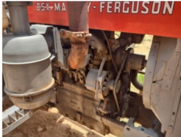
Foto 11: Transmissão de força exposta visão mais próxima
