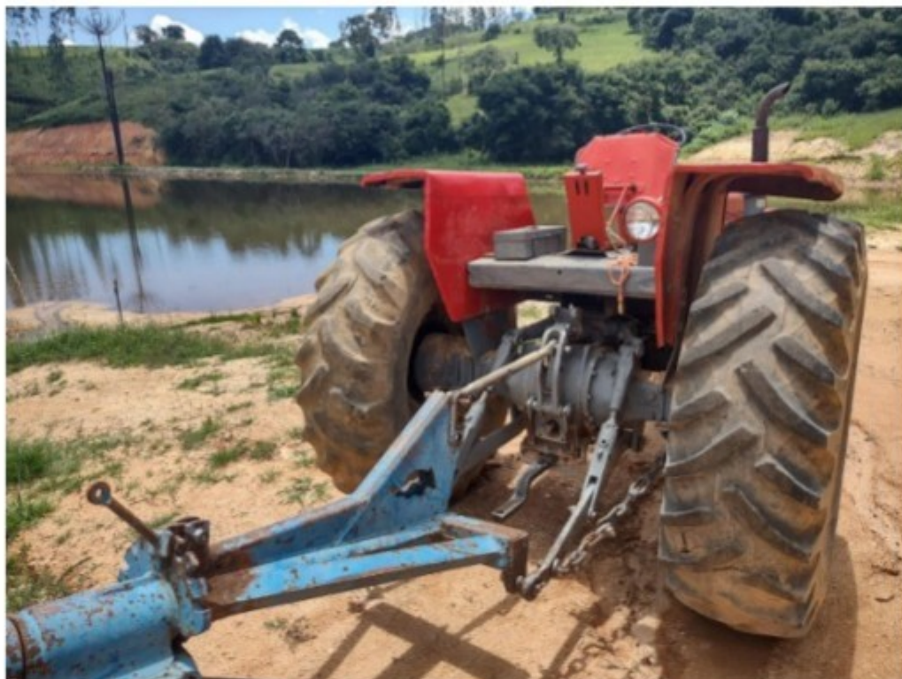
Foto 12: Trator Massey Ferguson 85 X, não foi instalada uma proteção que cobrisse a parte superior e as laterais da Tomada de Potência - TDP do trator - visão mais afastada
