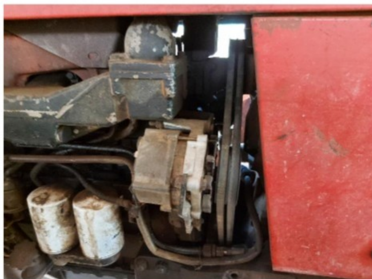
Foto 11: Transmissão de força (correias) dos tratores sem proteção
