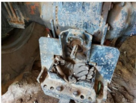
Fotos 9 e 10: Tomada de força dos tratores utilizados na fazenda sem proteção
