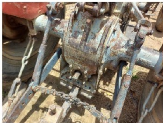
Fotos 9 e 10: Tomada de força dos tratores utilizados na fazenda sem proteção
