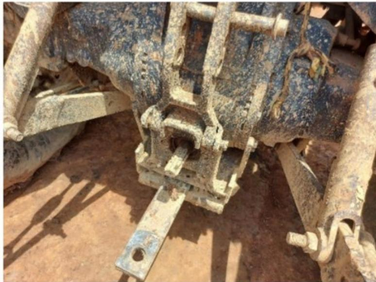
**Imagens:** Ausência de proteção que cubra a parte superior e as partes laterais da Tomada de Potência - TDP de tratores agrícolas.
