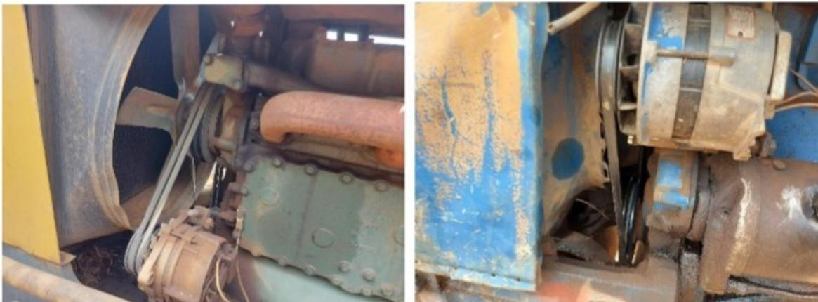
**Imagens:** Transmissões de força e componentes móveis expostos.
