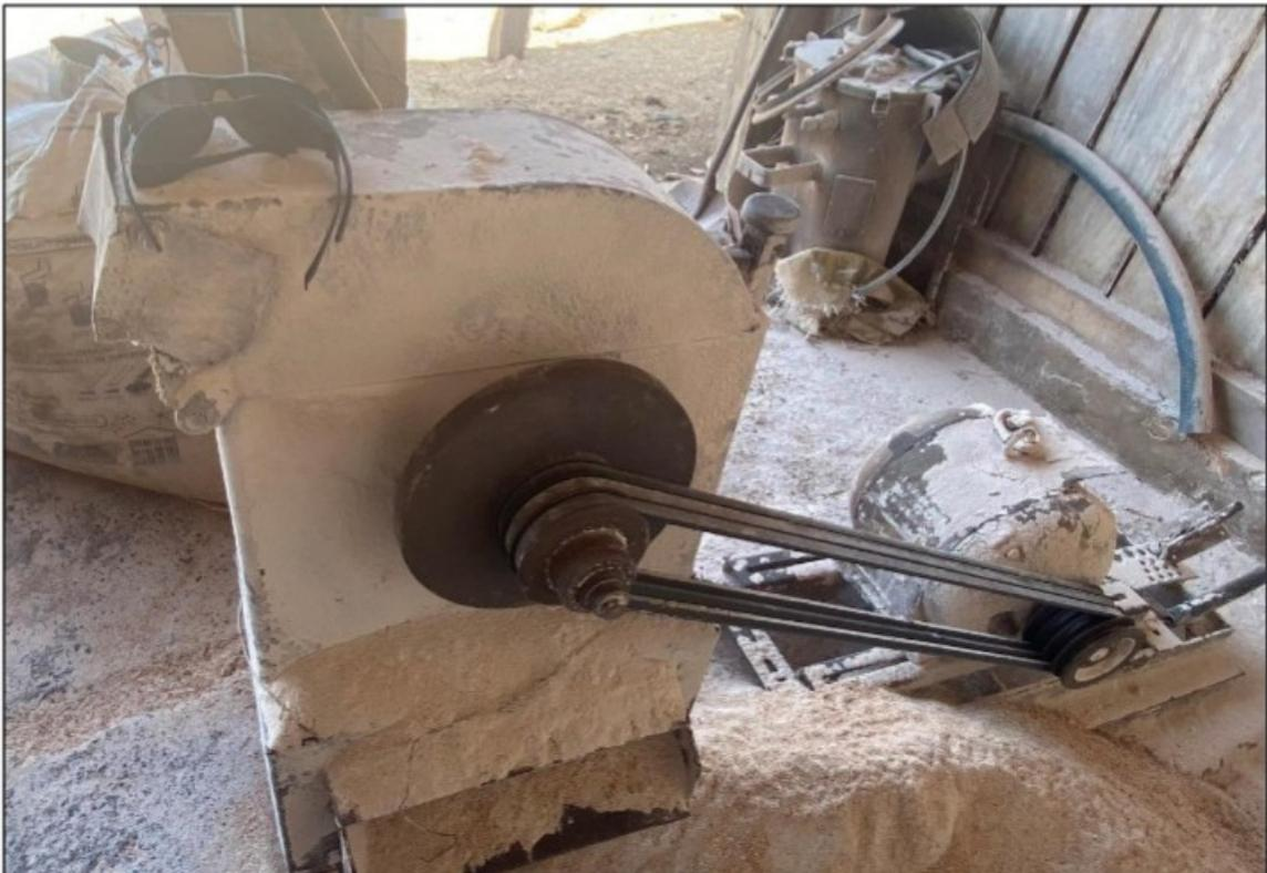
Imagem acima: Trituradora de milho com transmissões de força desprotegidas.
