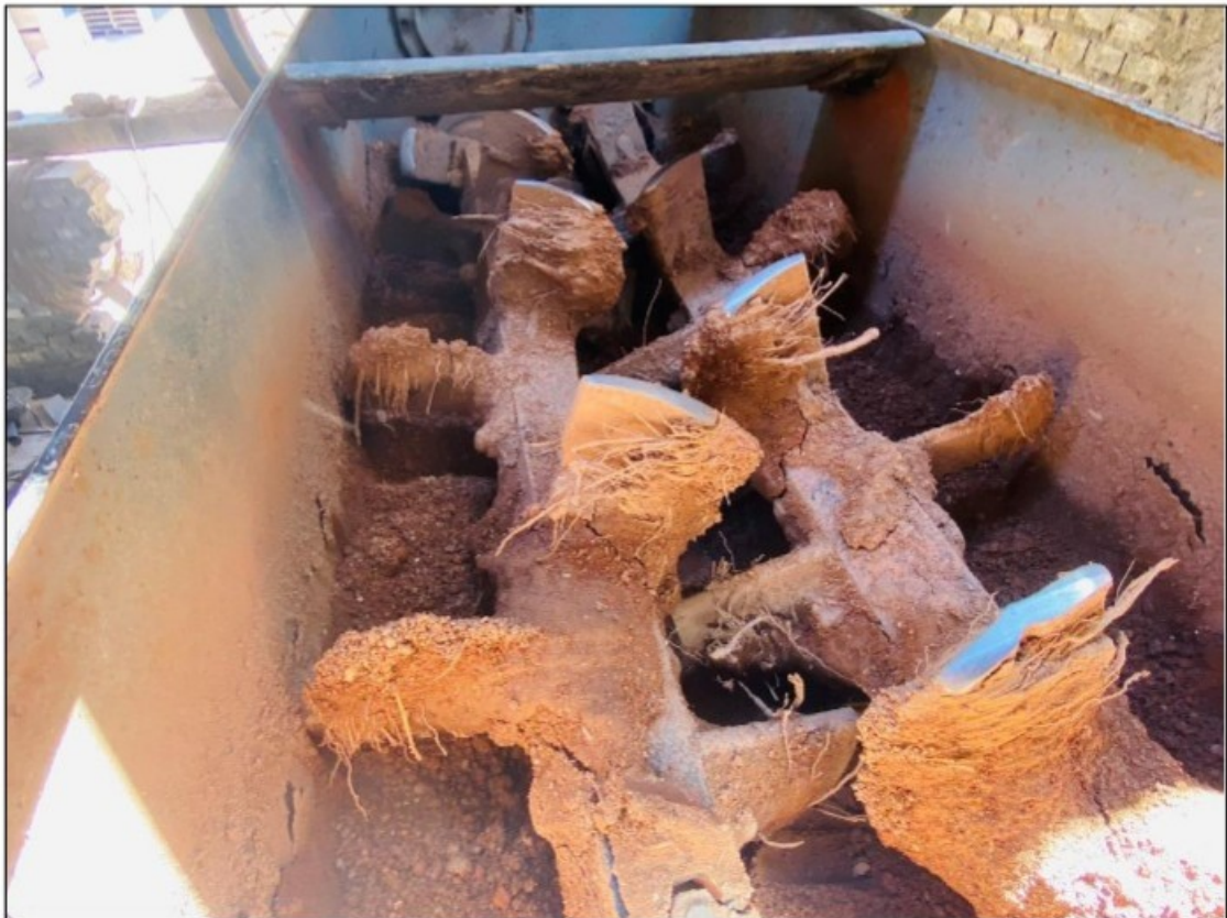
Imagem acima: Zona de perigo do misturador de barro ficava completamente exposta e acessível.
