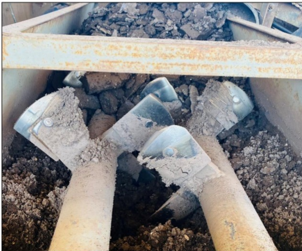
Imagem acima: Zona de perigo do misturador de barro ficava completamente exposta e acessível.
