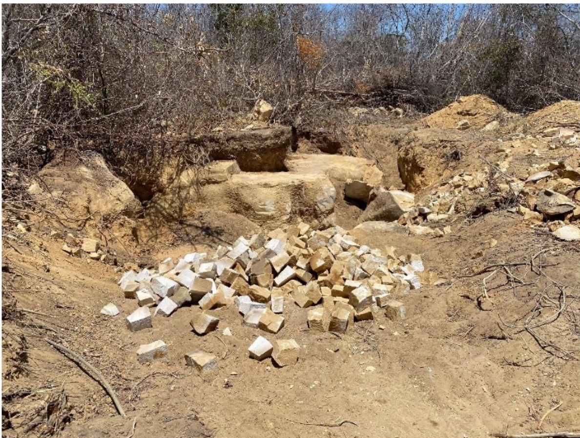
Foto 19: local de trabalho de confecção manual de paralelepípedos existente na pedreira fiscalizada.
