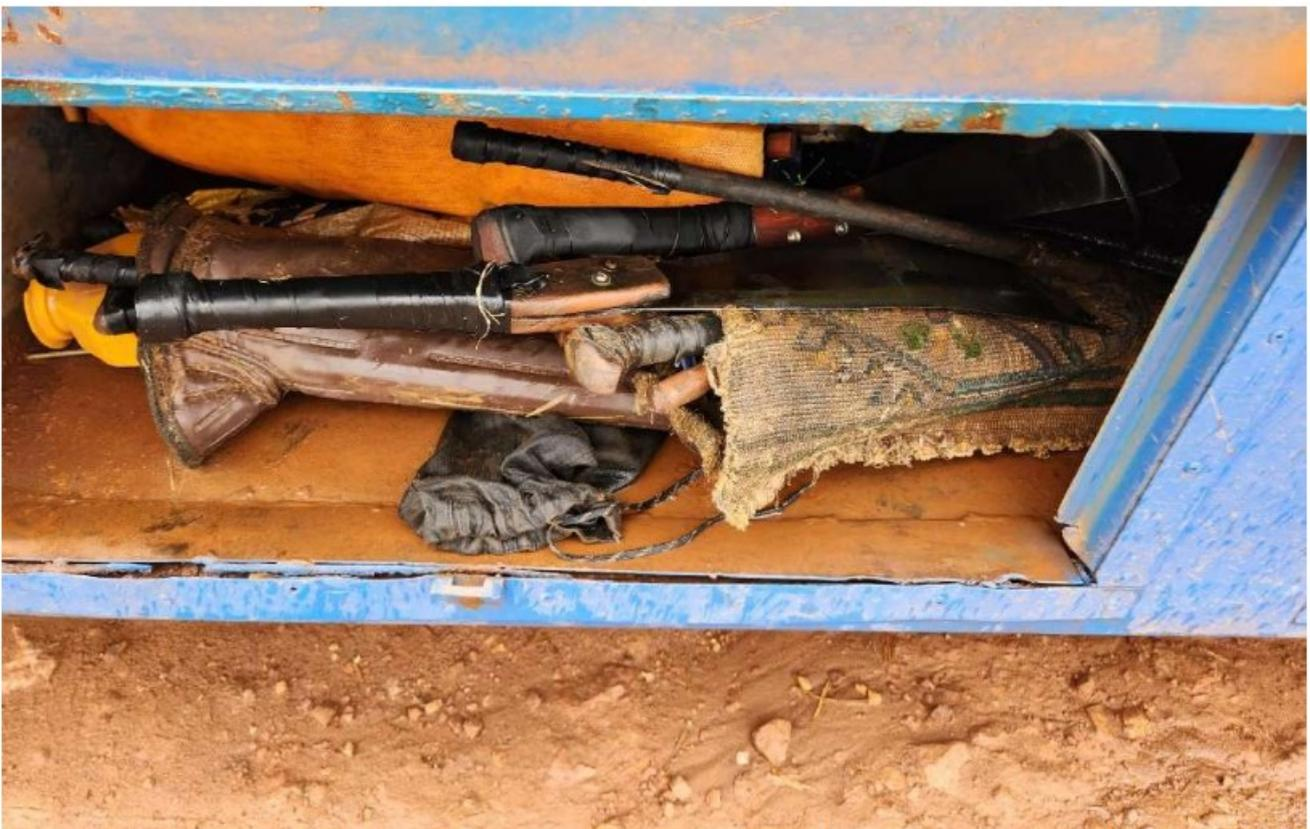
**Imagem 16** – Frente de trabalho de plantio de cana-de-açúcar: ferramentas de corte (podões) sem bainha de proteção das lâminas.
