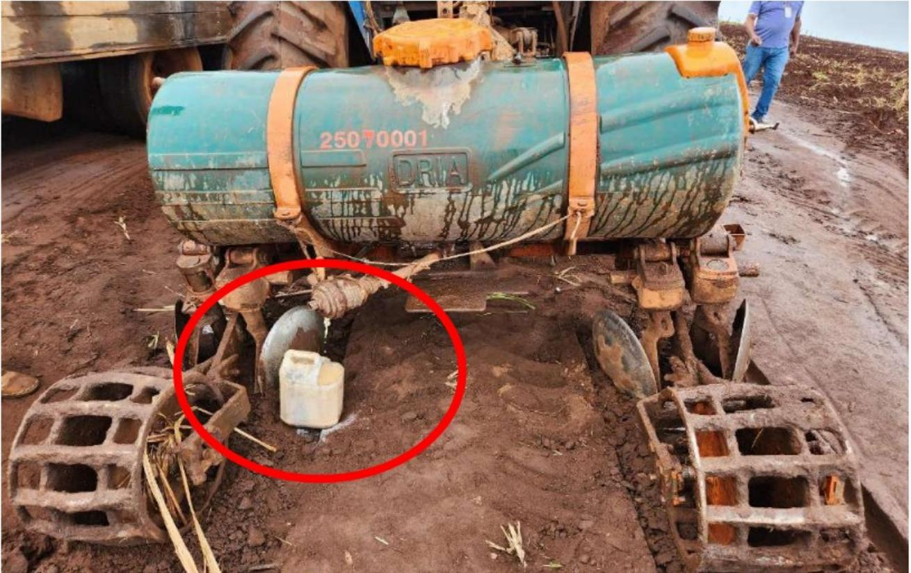
**Imagem 19** – Equipamentos de aplicação de agrotóxicos sem manutenção, com vazamentos de produtos (calda) de agrotóxicos.
