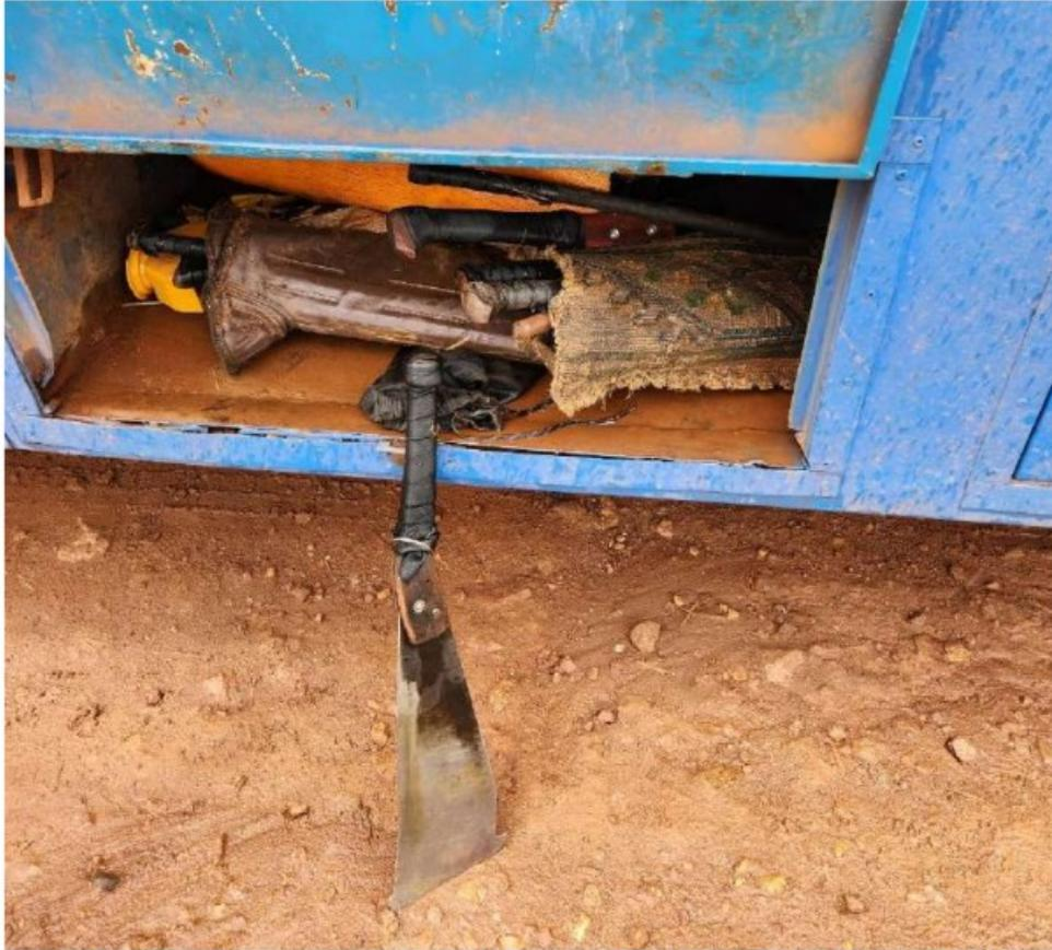
**Imagem 17** – Frente de trabalho de plantio de cana-de-açúcar: ferramentas de corte (podões) sem bainha de proteção da lâmina de corte.
