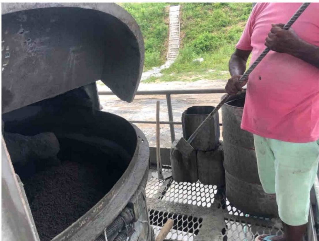
Figura 1 Máquina misturadora sem sistema de proteção.
