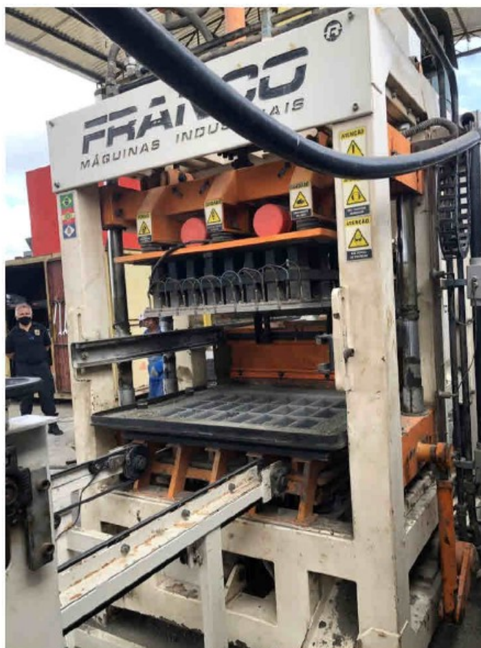
Figura 2 Martelo da prensa com acesso direto à área de prensagem.
