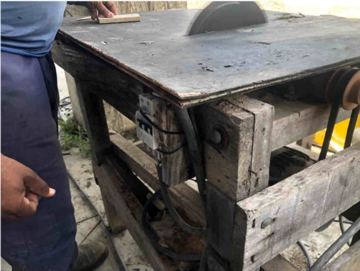
Figura 8 Serra Circular sem dispositivo de parada de emergência e sem sistema de segurança na sua zona de perigo.
