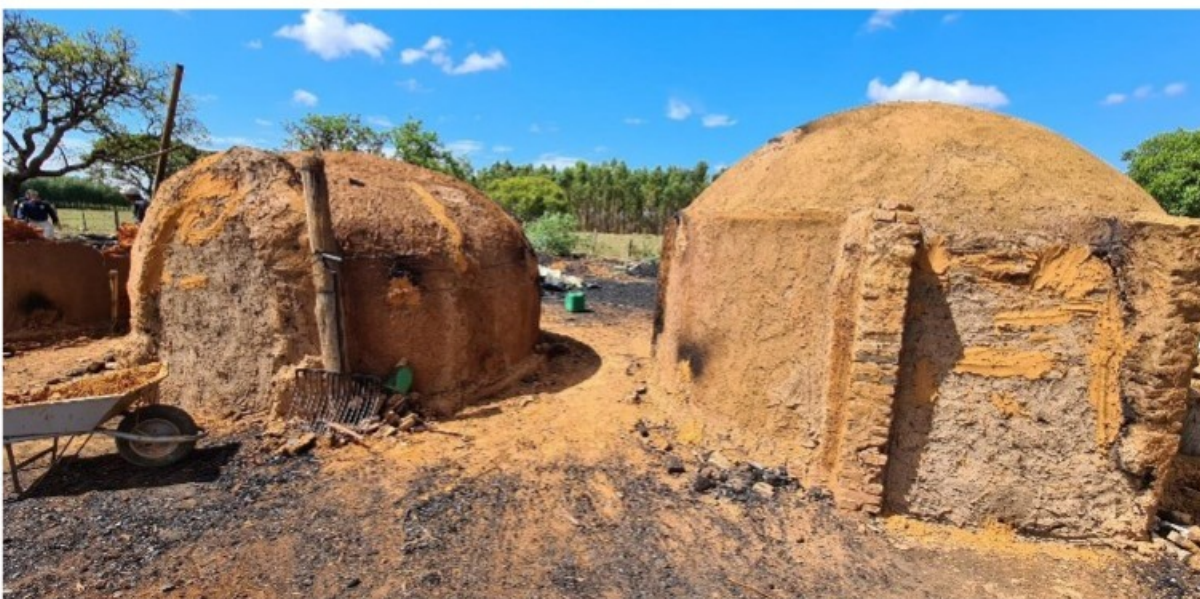
Imagem 3. Fornos barreados contendo carvão em seu interior. Registro fotográfico efetuado em 24/10/2022.
