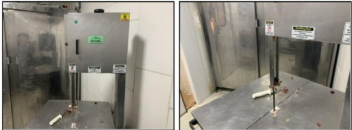
Figura 4 –Mesa fixa não dotada de guia regulável paralela à fita serrilhada.
