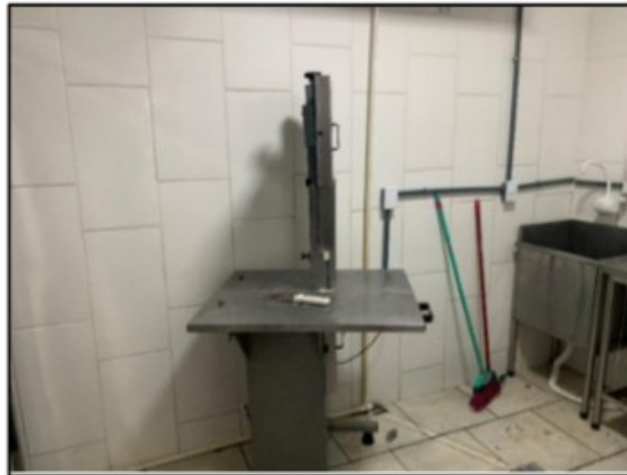
Figura 5 –Serra fita com mesa móvel sem guia que permitisse o apoio da carne
