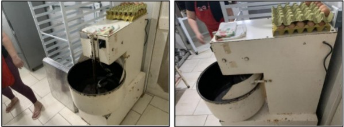
Figura 2 – Amassadeira sem proteção.
