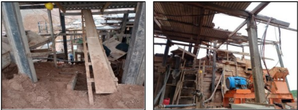
Figura 11 - Passarela sobre a planta sem guarda-corpo
