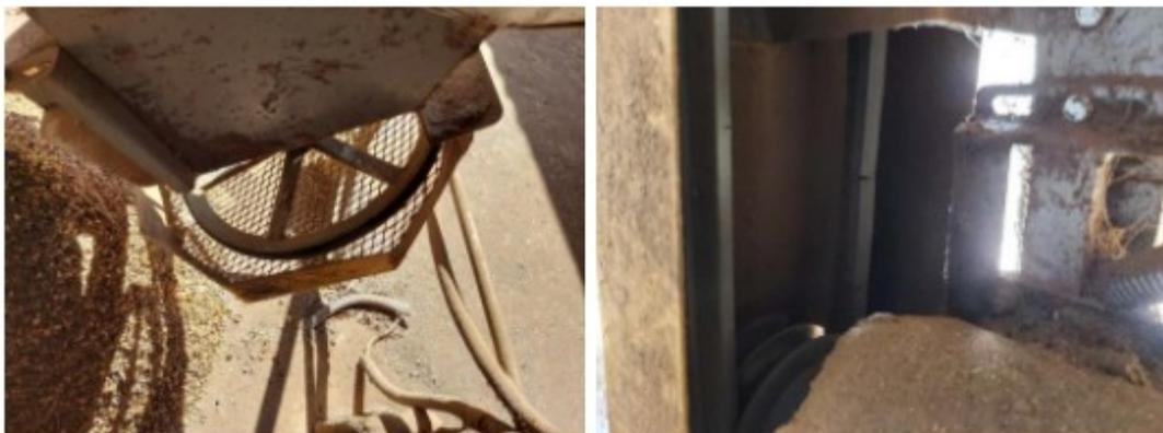
O item 31.12.24 da Norma Regulamentara 31 determina que as transmissões de força e os componentes móveis a elas interligados, acessíveis ou expostos, devem ser protegidos por meio de proteções fixas ou móveis com dispositivos de intertravamento que impeçam o acesso por todos os lados, o que não foi observado pelo empregador, conforme descrito.
