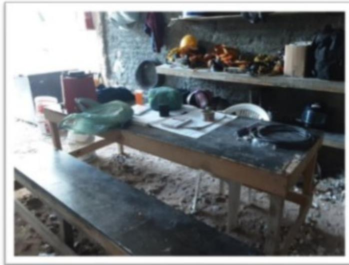
**Figura 8** - Local de tomada de refeições subdimensionados para 23 trabalhadores e sem condições de higiene e conforto. Os demais trabalhadores tomavam as refeições de forma improvisada no canteiro de obras. A mesa de tomada de refeições também era utilizada para finalidades diversas.
