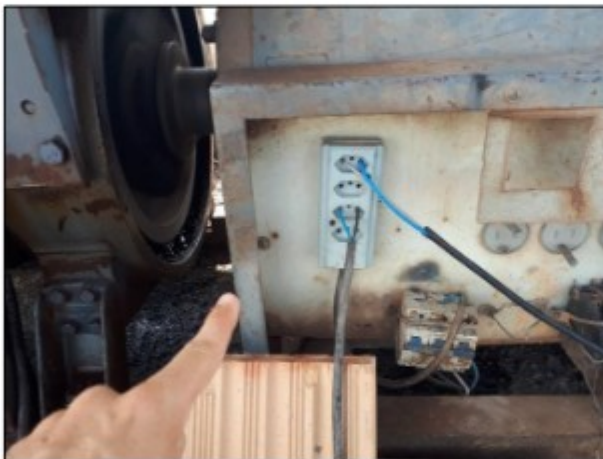
Imagens acima: Ausência de proteção das partes perigosas da betoneira, dispositivo de acionamento inadequado (disjuntor) e instalações elétricas improvisadas (como ausência de aterramento e fiação no chão em área de circulação de trabalhadores).
