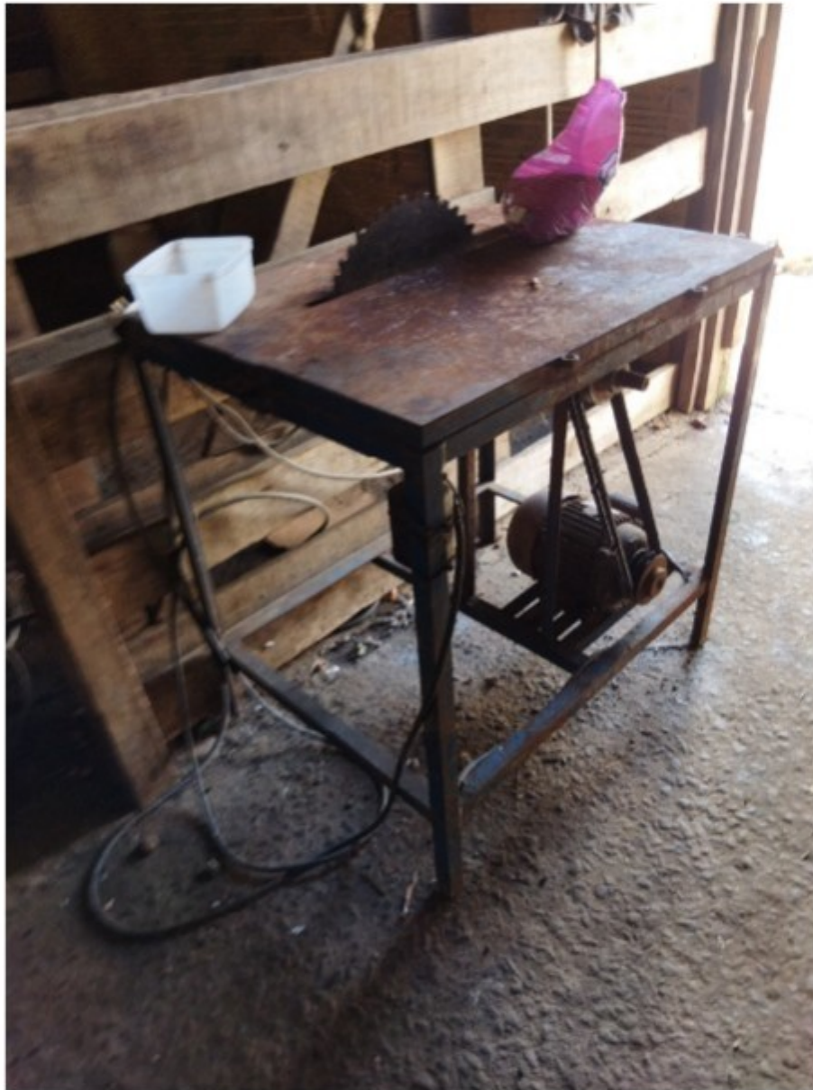
Foto de serra circular situada em área interna da edificação do alojamento, sem proteção na zona de perigo de sua parte superior (acima do tampo da mesa) e na transmissão de força da correia (abaixo do tampo da mesa)
