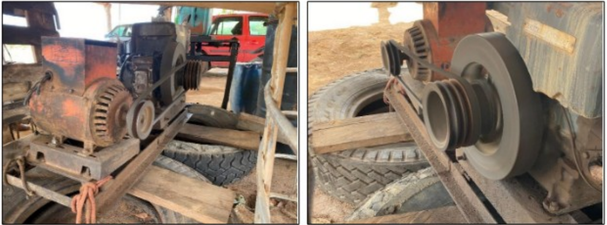
Fotos: Motor que era utilizado para gerar energia na Carvoaria, com transmissões de força sem qualquer proteção.
