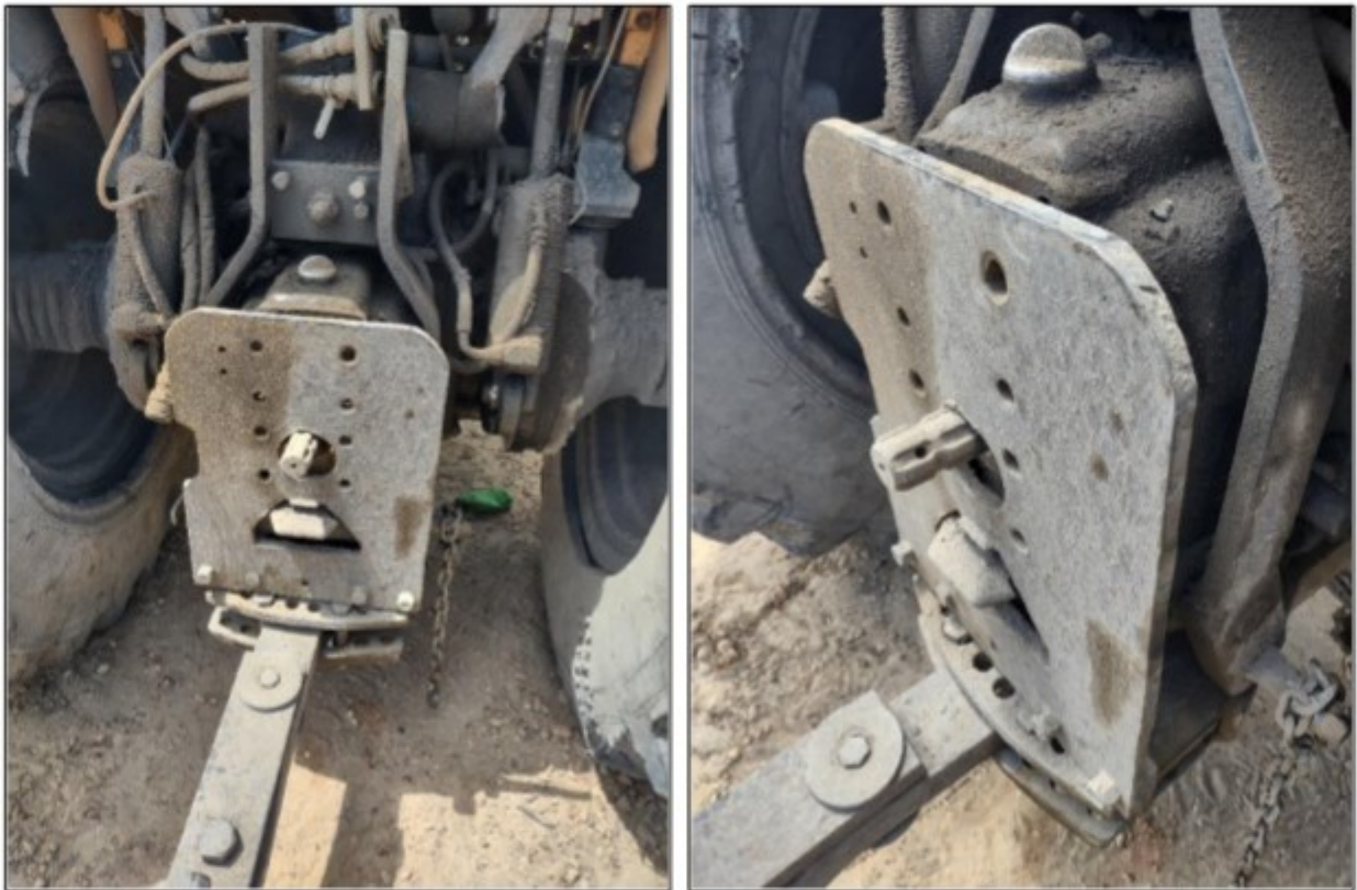
Fotos: Tomada de Potência (TDP) do Trator Valmet/Valtra sem qualquer proteção.
