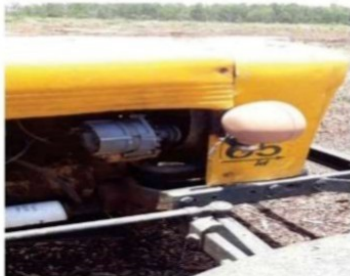
Figura 12: transmissão de força desprotegida no motor do trator.
