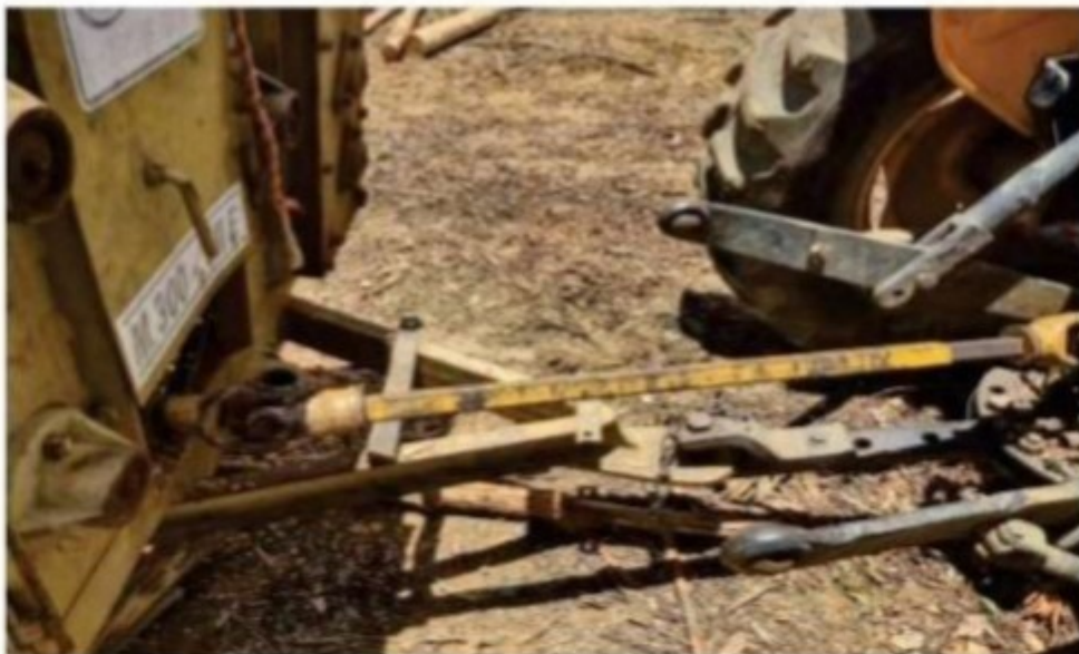
Figura 13: Eixo cardã desprotegido.
