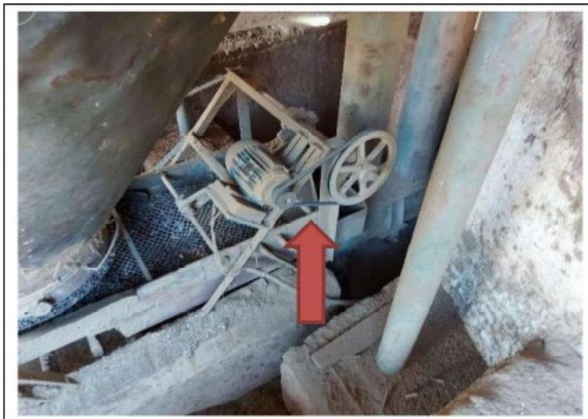
As transmissões de força das máquinas se situavam a menos de dois metros de altura, permanecendo acessíveis ao contato acidental nas zonas de risco representadas pelas partes móveis das transmissões de força. Esclarecemos que as mencionadas transmissões de força não estavam situadas dentro das estruturas das máquinas, gerando riscos de contatos acidentais pelo operador ou por outros empregados que estivessem circulando nas suas proximidades, podendo ocasionar amputações ou outras lesões graves.
