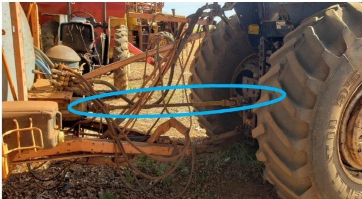
Imagem 04 – Eixo cardã sem proteção de um dos tratores na sede da gleba arrendada pelo Sr. [REDACTED]
