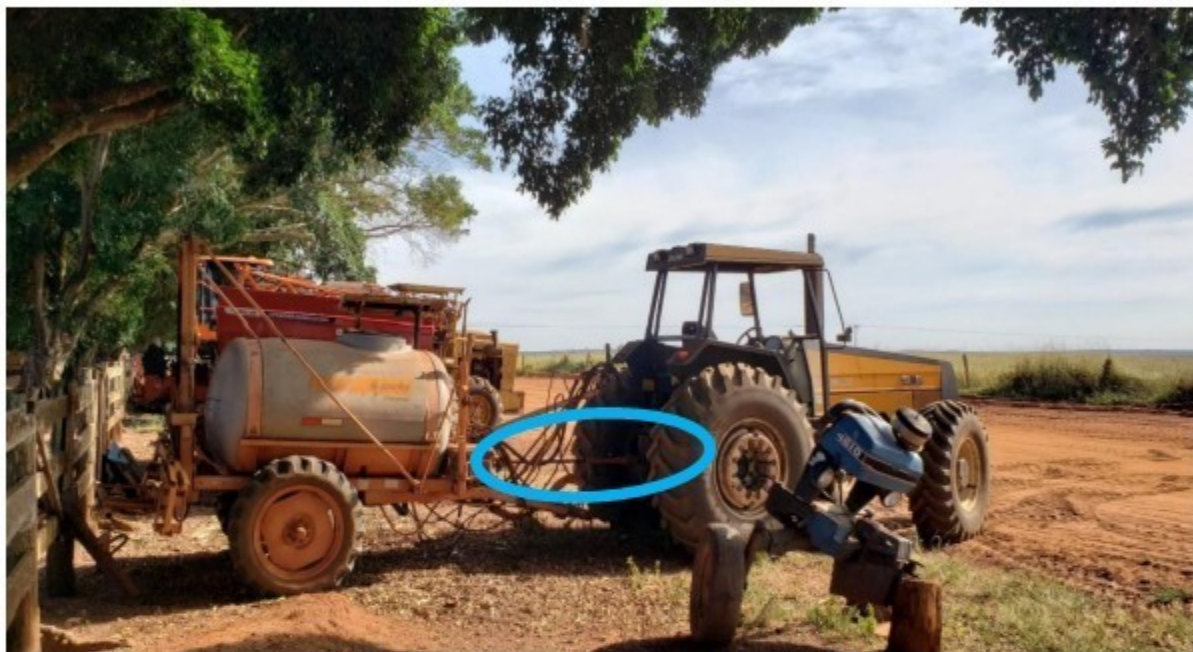
Imagem 03 – Eixo cardã sem proteção de um dos tratores na sede da gleba arrendada pelo Sr. [REDACTED]
