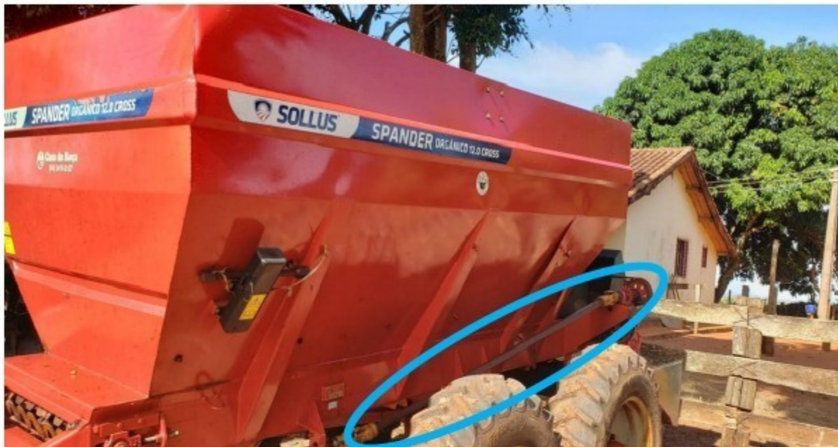
Imagem 05 – Eixo do cardã sem proteção de um dos implementos agrícolas (adubadora) na sede da gleba arrendada pelo Sr. [REDACTED]
