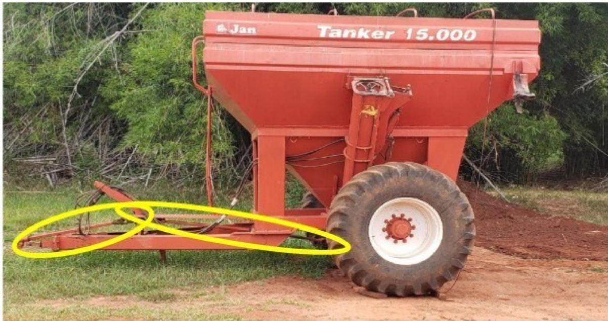
Imagem 23 – Eixo cardã sem proteção de um implemento agrícola de aplicação de adubo na Fazenda Campo Novo, de propriedade do empregador ora autuado (inspeção realizada em 29/04/2021)
