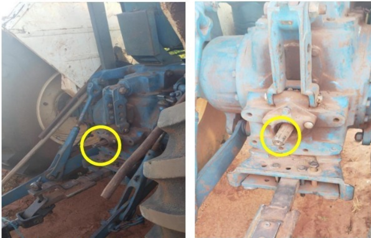
Imagens 21 e 22 – Tomada de Potência (TDP) do trator utilizado pelos trabalhadores resgatados nas atividades de limpeza de terrenos. O dispositivo sem proteção (detalhe) representava riscos de graves acidentes.
