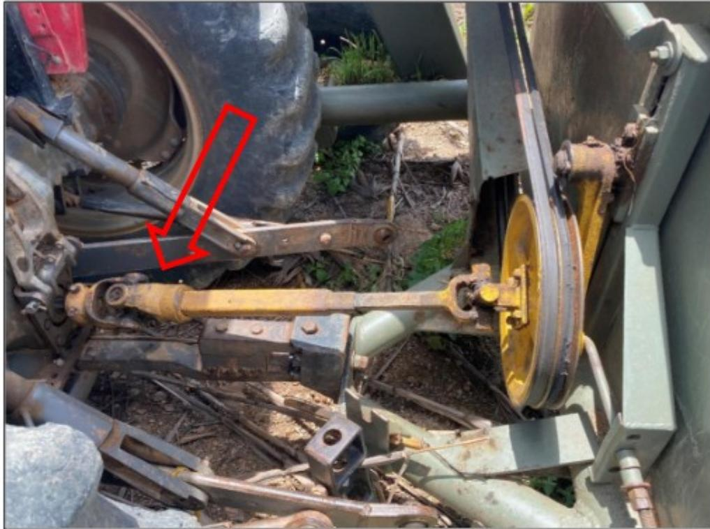
**Imagem:** Eixo cardã de outro trator (MASSEY FERGUSON, modelo MF 4275) sem proteção adequada. A máquina foi encontrada na mesma frente de trabalho visitada pela equipe fiscal.
