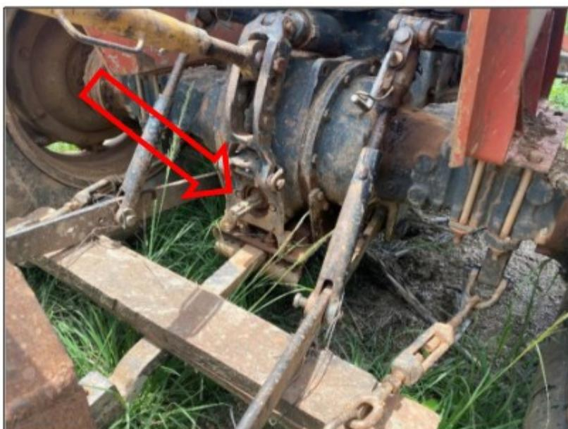
**Imagem:** Tomada de Potência - TDP do mesmo trator sem qualquer proteção.
