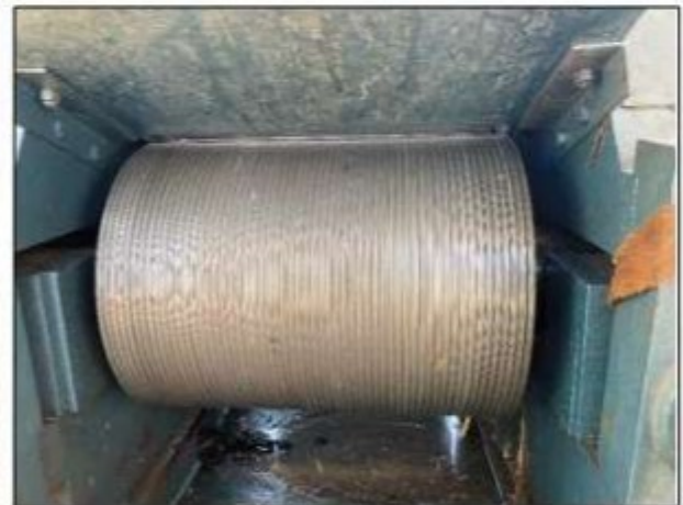
Imagens: Máquina que era utilizada para moer a cana de açúcar. As zonas de perigo estavam desprotegidas.
