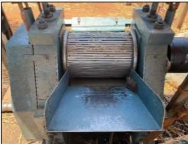
Imagens: Máquina que era utilizada para moer a cana de açúcar. As zonas de perigo estavam desprotegidas.
