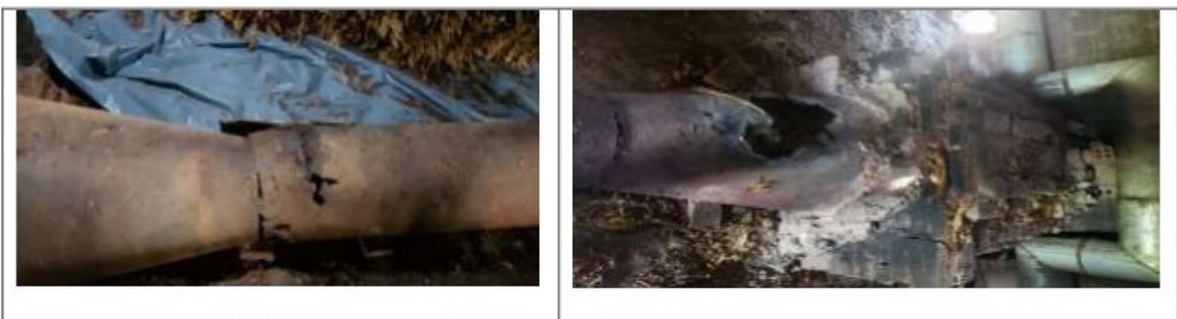
Registros fotográficos evidenciam a deterioração dos canos (rompidos) instalados nas estufas, havendo risco da ocorrência de incêndios.
