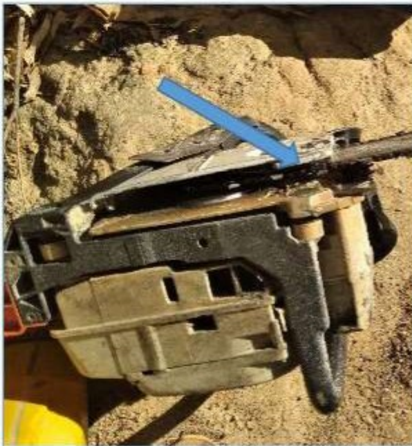
Imagens acima: Motosserra que era utilizada no corte de eucaliptos. As setas indicam a ausência do pino pega-corrente e a emenda improvisada no cabo punho arqueado.
