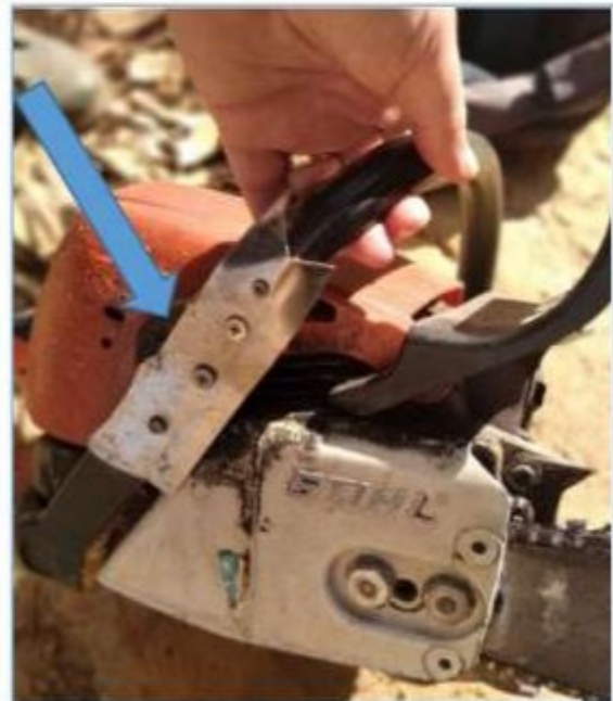
Imagens acima: Motosserra que era utilizada no corte de eucaliptos. As setas indicam a ausência do pino pega-corrente e a emenda improvisada no cabo punho arqueado.
