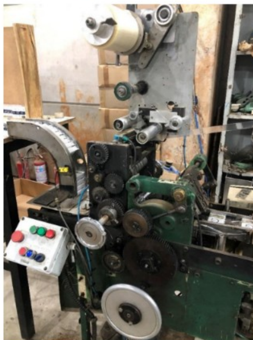
Foto 14 - Engrenagens totalmente expostas.
