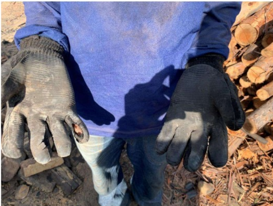
Foto 5: EPI (luva) danificada/rasgada
