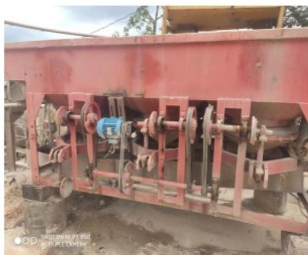
Figuras 4 e 5: partes móveis desprotegidas
