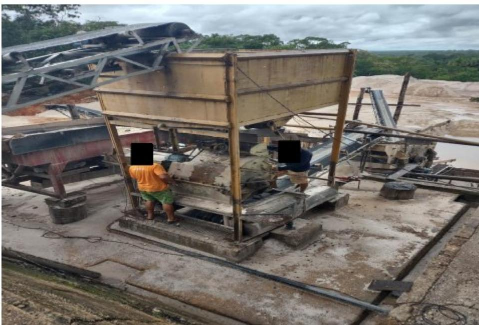
Figura 6: Trabalhador sob transportador contínuo desprotegido.
