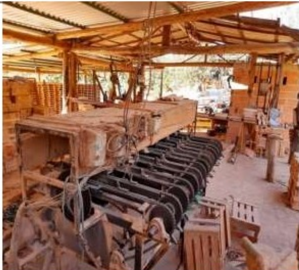
Máquina sem proteção
