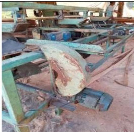
Foto enviada por e-mail após a inspeção no local, mostrando as providências tomadas com relação às proteções das máquinas.
