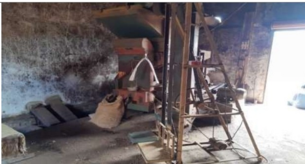
À frente: empilhadeira rústica, sem as devidas proteções; ao fundo: máquina para ensacar os grãos.
