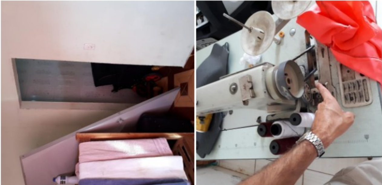
Quarto sem porta e máquina sem proteção
