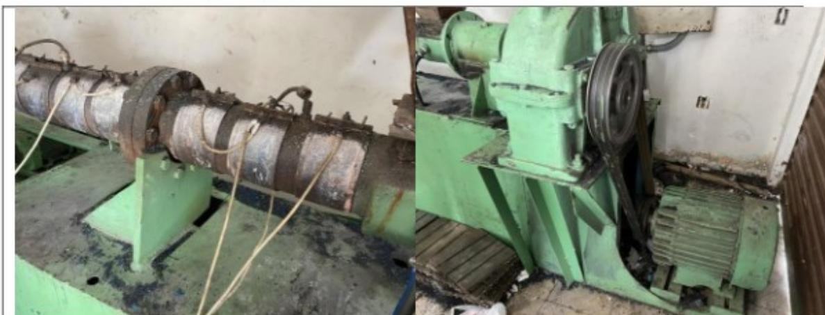
Foto 23- Terminais elétricos com partes vivas expostas no canhão da extrusora, que também é uma área que oferece risco de queimaduras, acessíveis aos trabalhadores e quem mais passasse pela área.
