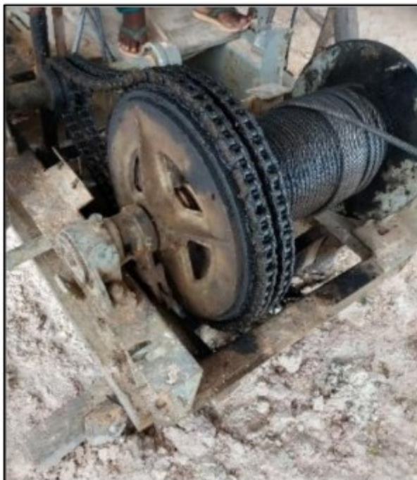
Imagem acima: Guincho de corrente que estava sendo utilizado pelo senhor [REDACTED]. Nas imagens inferiores estão evidenciadas as zonas de zonas de risco.
