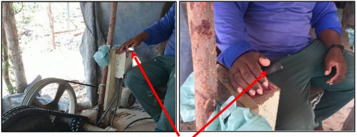
Imagens acima: As setas apontam a chave de partida do guincho ("Chave Lombard").
