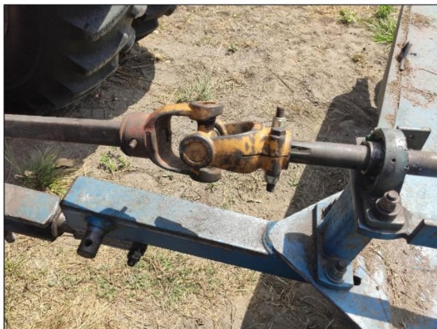
Foto: O eixo cardã do trator também não era dotado de proteção.
