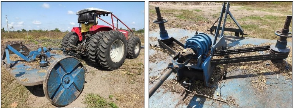
Fotos: As transmissões de força da roçadeira acoplada no trator não continham proteção.
