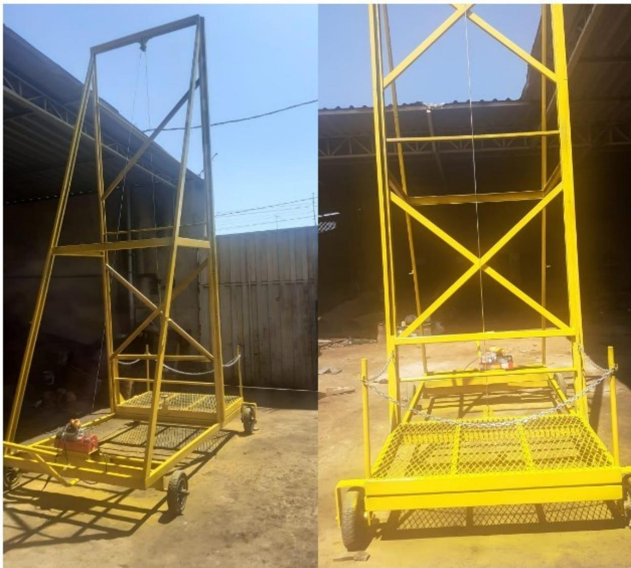
*Elevador sugerido pelo GEFM para içamento da carga de carvão ensacada ao caminhão em substituição a atividade precária realizada pelo trabalhador. Protótipo construído a pedido do proprietário da empresa fiscalizada*
