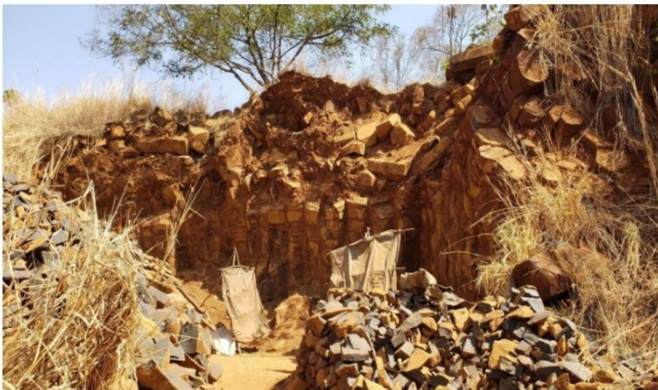
**Imagem 04** – Visão geral de um dos locais de extração de pedras de basalto da “Pedreira do [redacted]”
