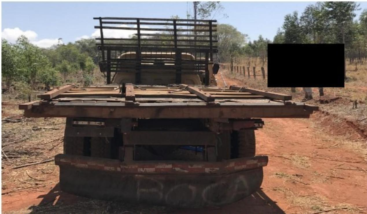
**Imagem 20** – Caminhão sem condições de uso, sendo utilizado por uma dupla de trabalhadores do Sr. [REDACTED] no transporte de madeira de eucalipto (sem manutenção, sem documentos, sem freio, com assoalho danificado etc)
