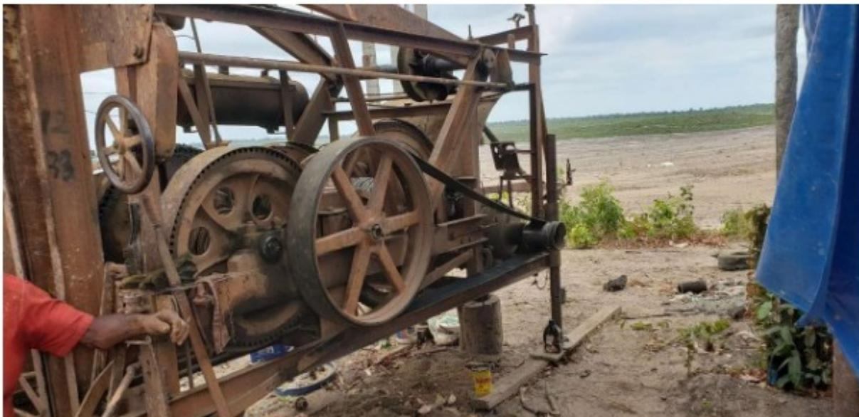
Fotografia: trabalhador operando a máquina, sem usa luva de raspa.
