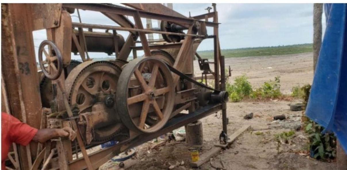
Fotografia: ausência de proteção, fixa ou móvel, no conjunto correia e polias da máquina.
