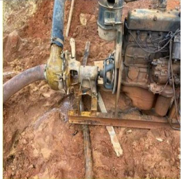
Motor sem proteção da parte móvel
