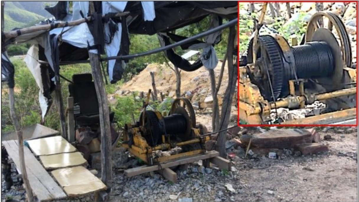
Imagem acima: Guincho utilizado na mina (no detalhe, partes móveis sem proteção).
