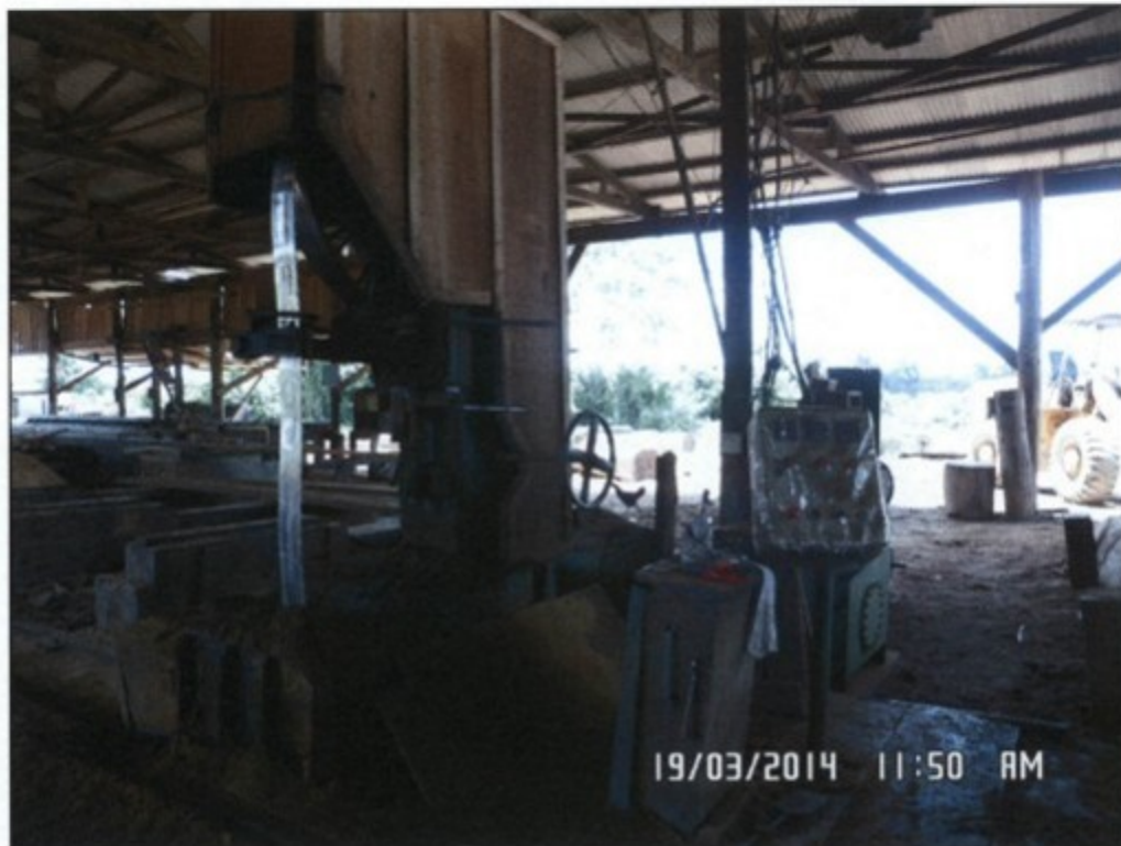
Zona de perigo da serra fita, sem sistema de segurança.
