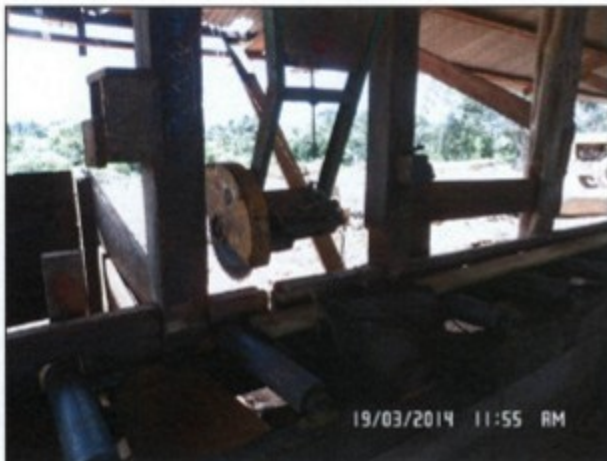
Máquinas não dotadas de dispositivo de parada de emergência.
