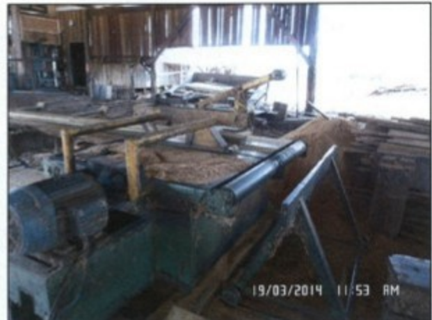
Máquinas não dotadas de dispositivo de parada de emergência.
