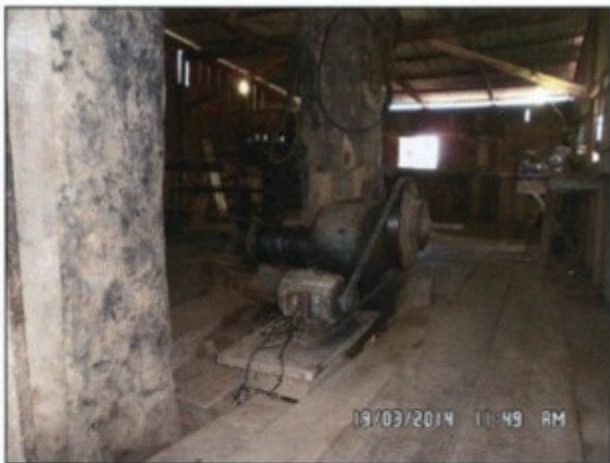
Máquinas com transmissões de força desprotegidas.
