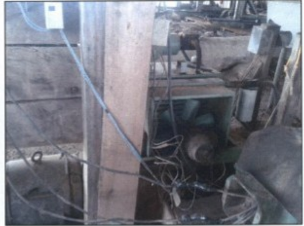
Instalações elétricas de máquinas, acarretando perigo de choque elétrico, incêndio e outros acidentes.
