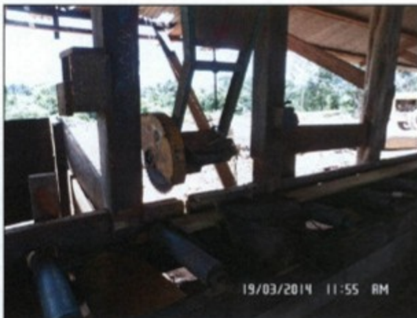
Máquinas acionadas através de chave tipo "Lombard"
