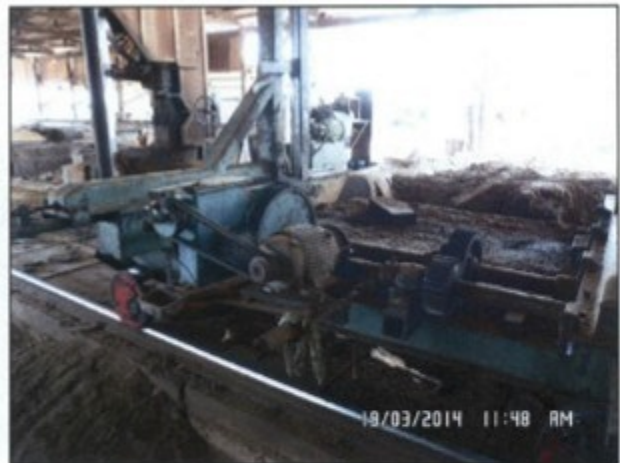
Máquinas com transmissões de força desprotegidas.
