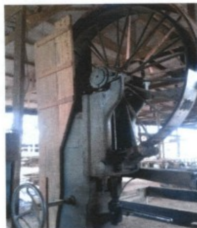
Maquina serra fita sem proteção da zona de perigo
