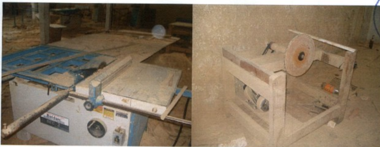
Fotos 3 e 4 – Ausência de sistemas de segurança em zonas de perigo de máquinas e equipamentos.
