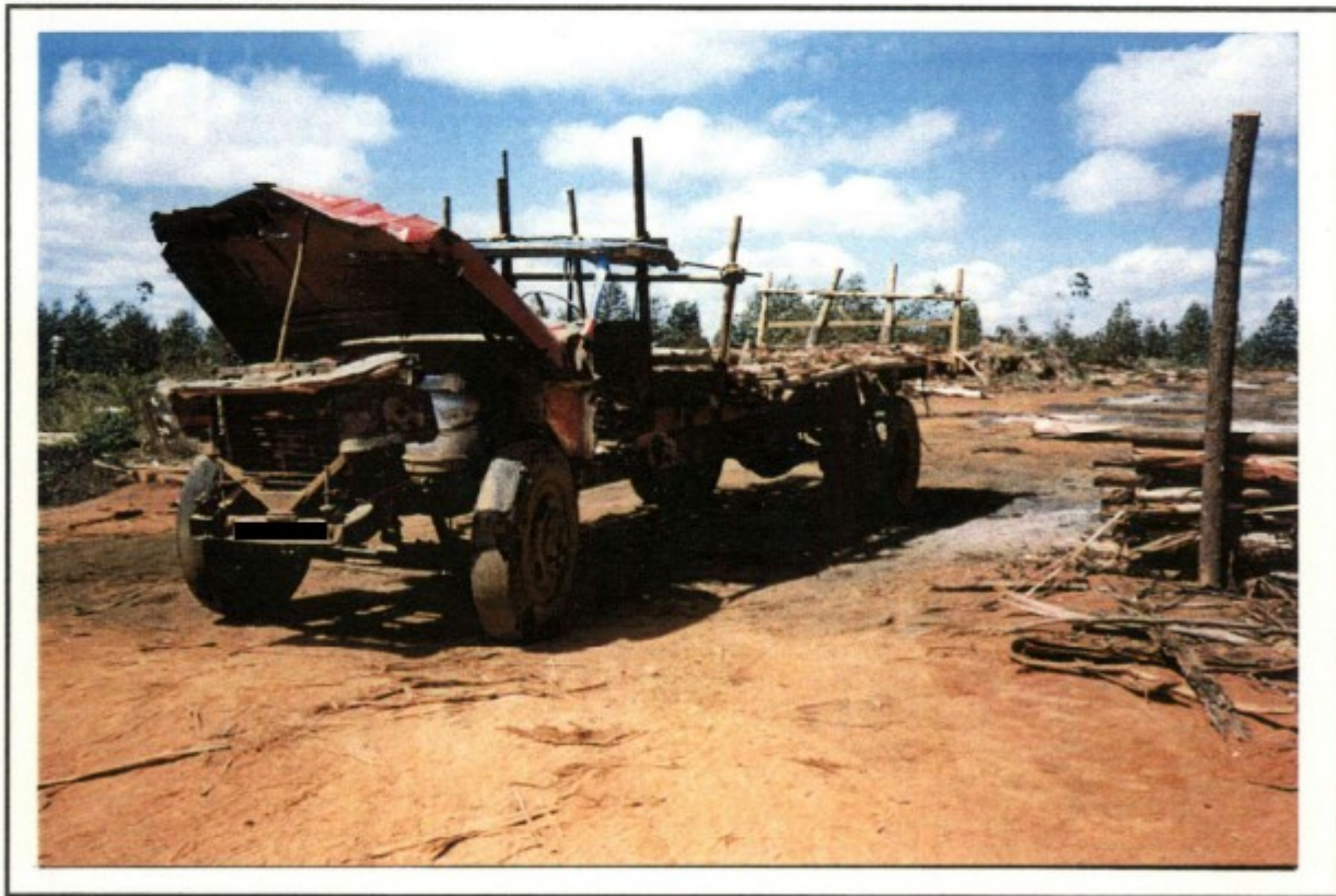
CARVOARIA DO EMPREITEIRO [REDACTED] CAMINHÃO SEM CABINE, SEM FREIO E MOVIDO A GLP.
