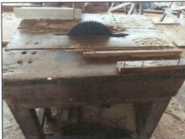
Fotos: Máquinas sem proteção contra projeção de suas partes e outros materiais.
