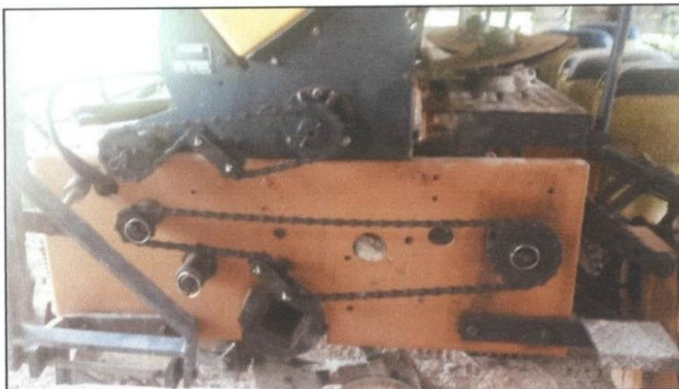
Fotos: Zonas de perigo das máquinas expostas.
