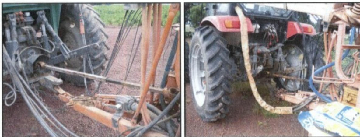
Fotos: Eixos cardã das máquinas supracitadas desprotegidos.
