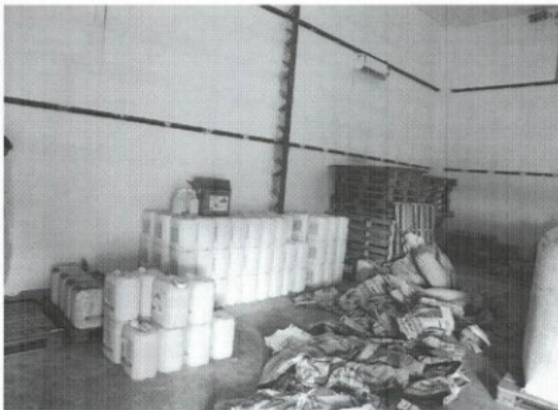
Foto 6: armazenamento de agrotóxicos diretamente sobre o piso e encostados à parede.
