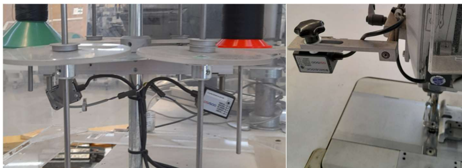
Imagem 5 – sensores de detecção de erros
