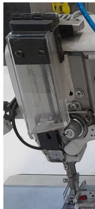
Imagem 4 – sistema de ajuste automático de tensão do fio
