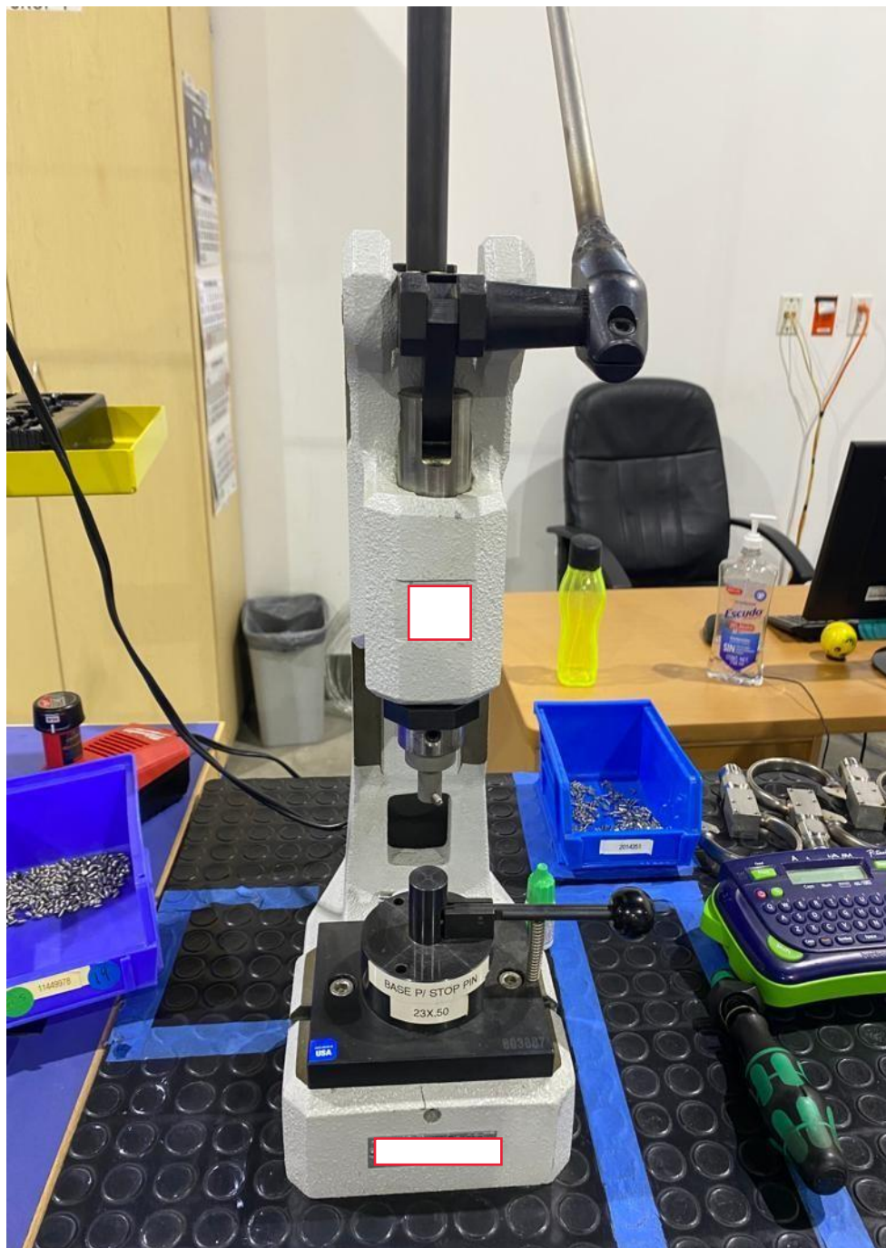
Foto n° 01 – Vista geral do dispositivo mecânico de furação do mostrador, para montagem do pino de encosto do ponteiro utilizado em manômetro com tubo Bourdon.
